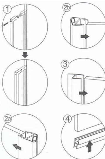
⚠ Место для установки должно быть выровнено по вертикали и горизонтали. Ограждение должно располагаться строго вертикально. Ход двери должен быть плавным.
