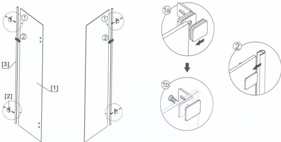
3. С помощью уровня выставить данную конструкция вертикально на поддоне. Наметить отверстия для крепления уголков к стене. Закрепить угла с помощью винтов М 4х35.
