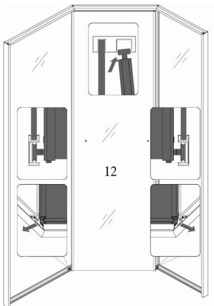
6. Установка магнитного профиля (поз.6) и уплотнителя (поз.9)
