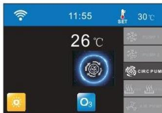
5. Функция подогрева (опционально): если эта функция запущена, то циркуляционный насос (фильтрация) будет работать дальше. Если циркуляционный насос (фильтрация) отключить, то подогрев также отключится.
